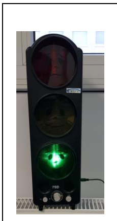
Abbildung 3: Beispiel für technisches Hilfsmittel „Lärmampel“ zur Schallmessung (Foto: C. Maurischat)
